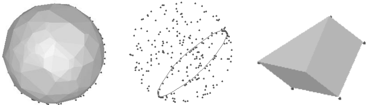
Bild 5: Konvexe Hülle von Punkten der dritten Dimension und zugehörige Schnittfigur. Schnittfigur (Prisma) eines Simplex vierter Ordnung mit einem Raum.
